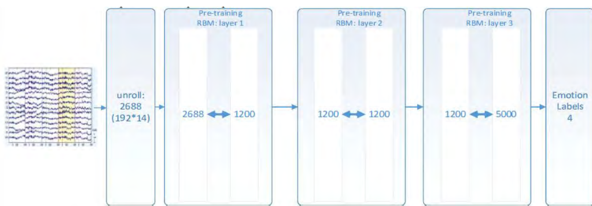
شکل ۲- معماری یادگیری عمیق با سه لایه از RBM
